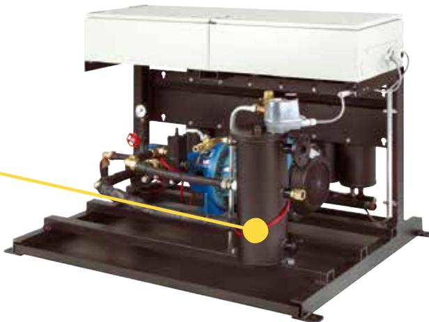
Условием равномерной вязкости при распылении является постоянство температуры топлива во всем диапазоне мощности горелки.
